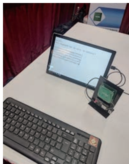
富士通セミコンダクタ+PHYCHIPS：ワイヤレス&バッテリーレスキーボード。外部からの電波発信を受けて電気を起こす電子タグの仕組みを機器制御に利用している
