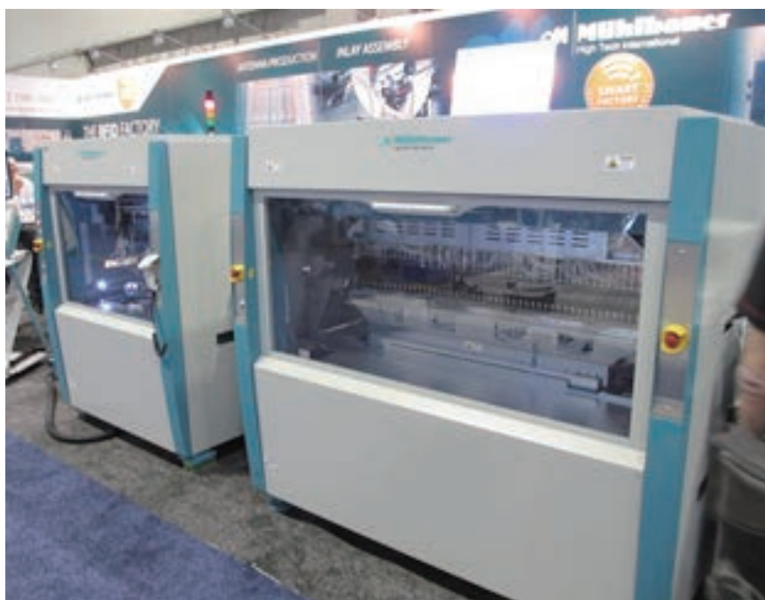
ミュールパワー社：インレイプリンタ。毎時10万枚の速さでアンテナに2mmのICチップを取り付けてインレイを作る
