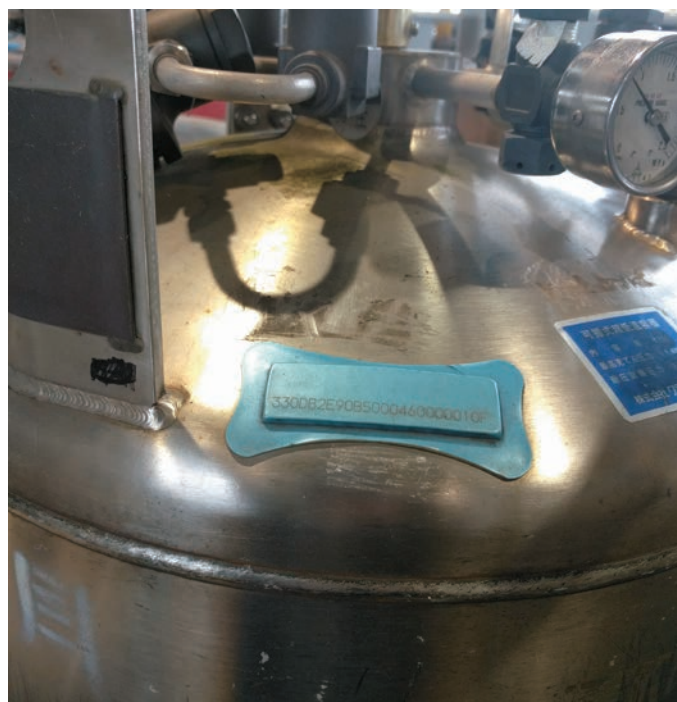
RFIDによる管理がされている高圧ガス容器
