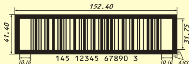
ITFシンボルの基本寸法 (単位: mm)
