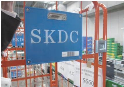
カートラックに取り付けられたRFタグ。金属タグを使わずにオリコンと同じタグにできたことでコスト削減につながった
