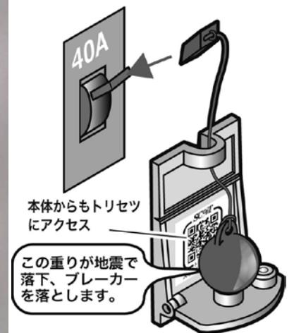
写真2 QRコードをつけた「通電火災防止器」
