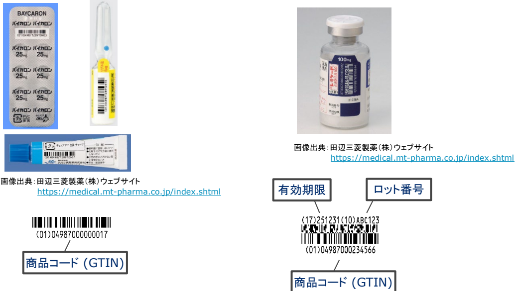
図 5.3.1-1 調剤包装単位(アンプル、バイアル、PTP シート、軟膏チューブなど)へのバーコード表示例
