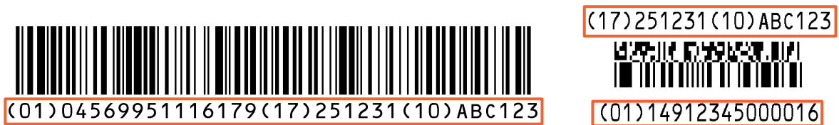
図 5.2-1 HRI の例 (GS1-128 シンボルと GS1 データバー限定型合成シンボルの例)
