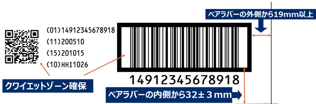
図表 15 ITF シンボルと GS1 QR コードの配置
