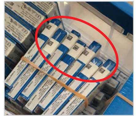
写真2 RFIDタグが貼付された対象製品。読み漏れを防ぐため、タグ部分が重ならないように少しずつずらして輪ゴム留めされている。
