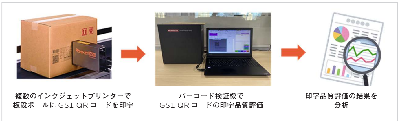
図3 印字テストの実施方法
