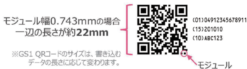
図4 GS1 QRコードのモジュールおよびサイズイメージ
