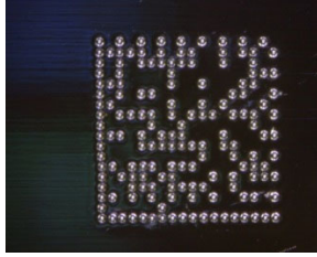
図 4-10 1セル1×1ドットの出力サイズの違う二次元シンボル ドットの大きさ、ドット間の距離を自動調整する（写真は同倍率で撮影）。
