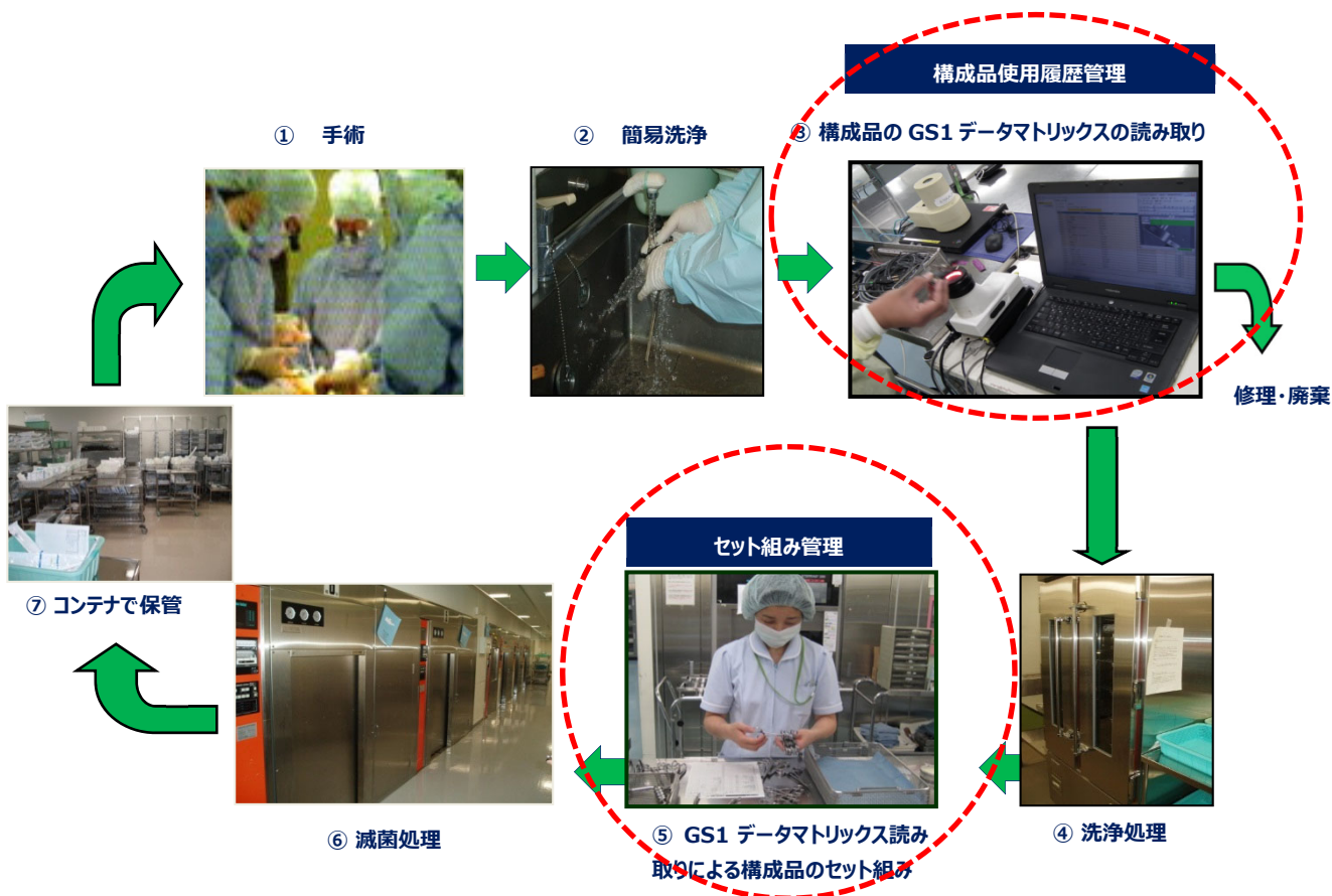
図 3-1 内視鏡構成品の洗浄・滅菌処理業務の流れ
