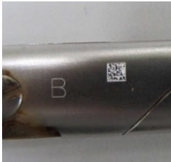
図 4-11 マーキング実施後 24 時間塩水噴霧試験結果
