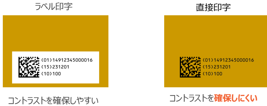
図 4-1 ラベル印字と直接印字
