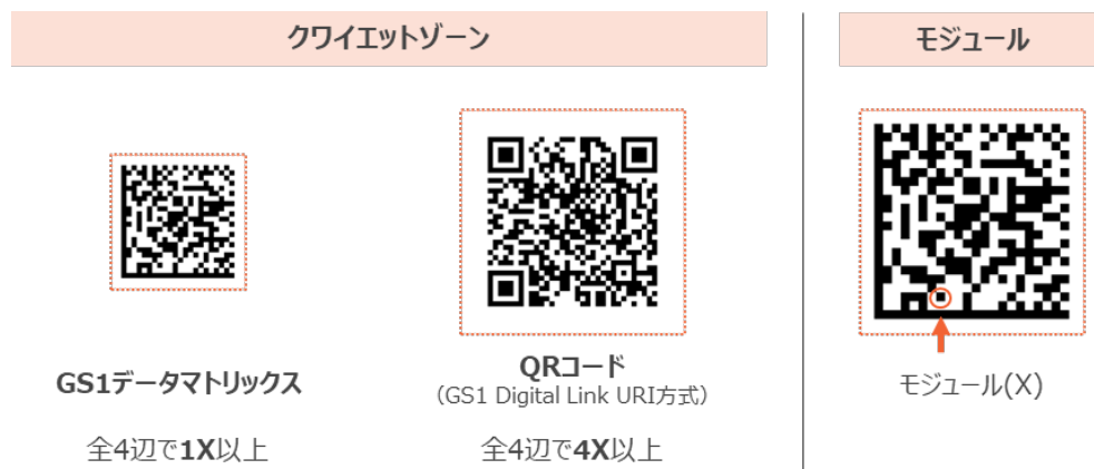
GS1 二次元シンボルのクワイエットゾーンとモジュール
