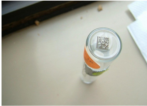
図 4-2 GS1 データマトリックス レーザーシンボル
