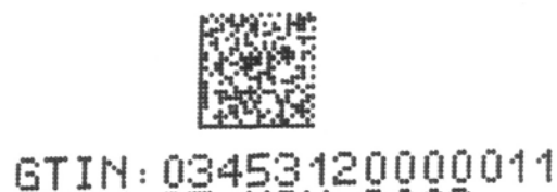
図 4-1 インクジェットで印刷された GS1 データマトリックス
