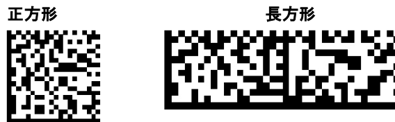
図 1-2 正方形シンボルと長方形シンボルの比較
