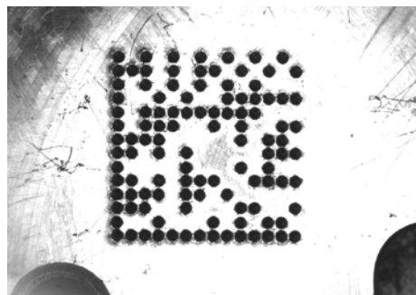
図 4-3 GS1 データマトリックス ドットピーンシンボル
