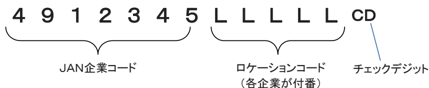
図4-18 GLNのコード体系（7桁JAN企業コードを使用した例）
