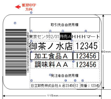
図4-20 B1ラベル、縦バーコード（28桁）の印字例
