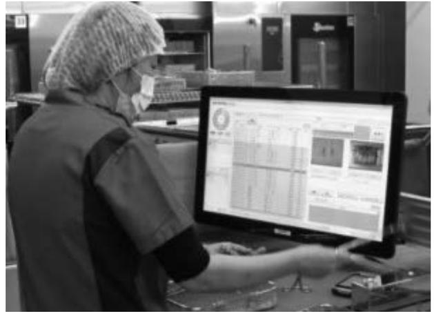
写真② 鋼製器具一本一本の二次元シンボルを読み取り、手術器具のトレーサビリティを確保
