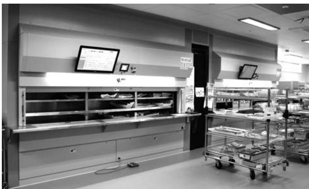
写真④ 垂直回転棚は、携帯情報端末から手術スケジュールナビ機能で自動回転し、収納やピッキング作業を行うことができる
