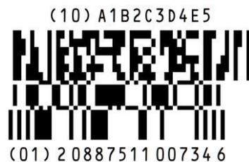
図 28 : GS1 DataBar (二層型) による GTIN と、GS1 Composite Component によるバッチ/ロット番号
