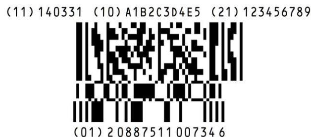
図 29 : GS1 DataBar (二層型) による GTIN と、GS1 Composite Component による製造年月日・バッチ/ロット番号・シリアル番号
