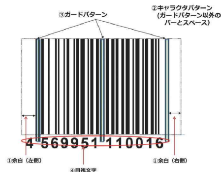
図表1 標準 JAN シンボル(13桁)の構成要素
