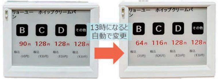
電子棚札にはグループごとの価格が表示され、日時によって自動的に価格が変更される
