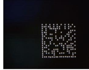
図 4-10 1セル1×1ドットの出力サイズの違う二次元シンボル
